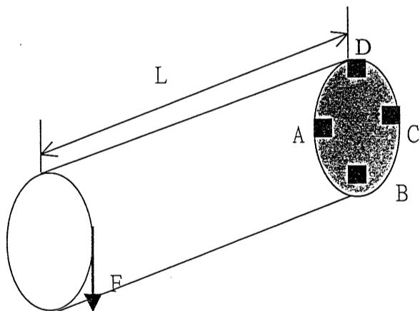
8. 一中碳鋼棒直徑 10mm，降伏強度  $35\text{kgf/mm}^2$ ，抗拉強度  $50\text{ kgf/mm}^2$ ，請問用它來吊起 1000kg 的汽車時，鋼棒是否會斷裂？或產生塑性變形？請計算其安全係數，以數據說明你對此問題的評估。
